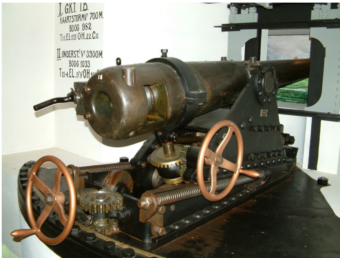
Een 10 cm. kanon op kazemataffuit zoals gebruikt in de forten van de Stelling van Amsterdam. De foto toont een opstelling zoals te zien was in het Artillerie Museum Oldebroek. (René Ros, 2004)
